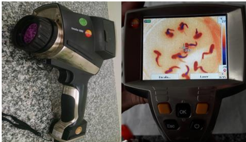
Figura 5: Termográfica Testo 881. Imagem térmica de plântulas de Sesbania virgata . Foto: Eliene Santos
